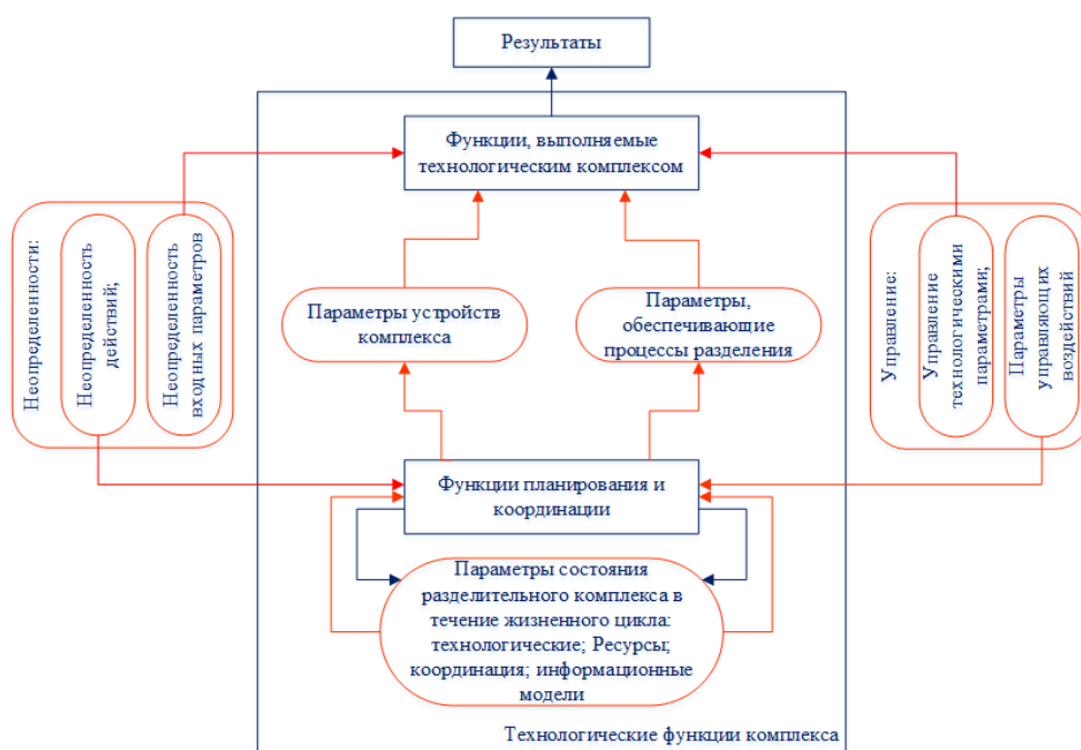
Рис. 2. Технологические функции разделительного комплекса.
